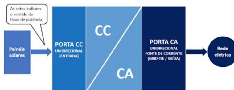
Figura 7: Fluxo de potência do inversor on-grid
