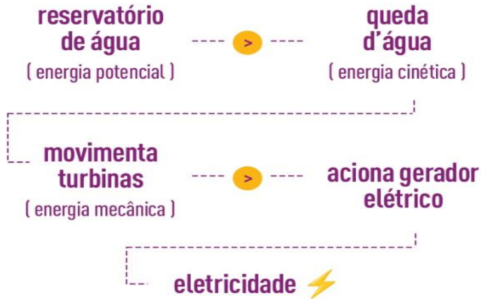
Figura 18 – Funcionamento de uma hidrelétrica
